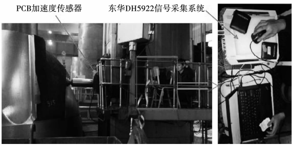
图 4 铣削 508Ⅲ钢试验现场图 Fig. 4 Test site diagram of milling 508Ⅲ steel
